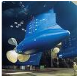
รูปที่ 11 ระบบใบพัดเรือเดินทะเลที่ขับเคลื่อนด้วยมอเตอร์
